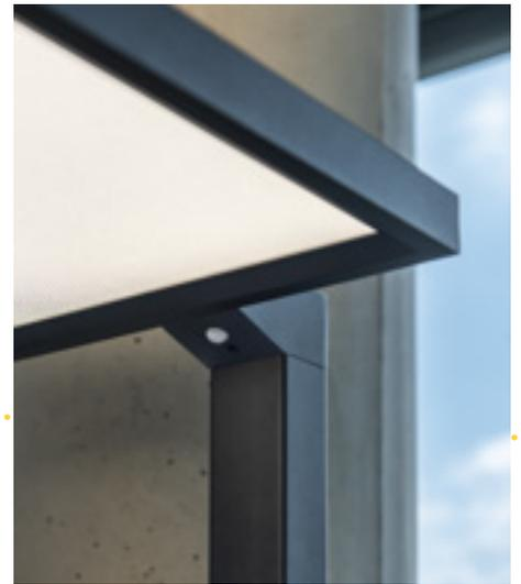
Tageslicht- und Bewegungssensor (PIR) reduziert die Lichtleistung nach 30 Minuten ohne Bewegungserkennung. Nach weiteren 30 Minuten wird die Leuchte automatisch ausgeschaltet.
